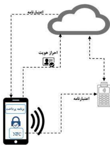
(شکل-۴): نحوه کارکرد HCE
