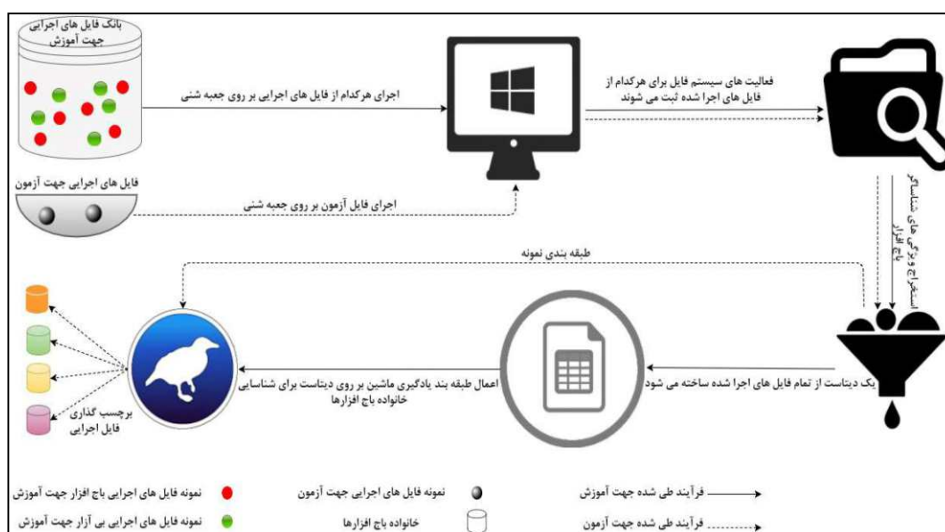
(شکل-۱): فرآیند طرح پیشنهادی (در معماری پیشنهادی ابتدا فایل اجرایی بر روی جعبه‌شنی اجرا می‌شود و سپس بر اساس ویژگی‌های مطرح شده که از تعاملات باج‌افزار با سیستم فایل استخراج می‌شوند و اعمال آن بر مدل ساخته شده می‌توان خانواده باج‌افزار را شناسایی کرد.)
