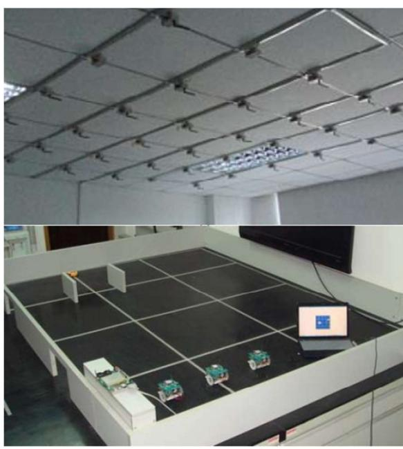
(شکل-۶): سامانه نظارتی تشخیص آتش‌سوزی ساختمان [۳۱]
