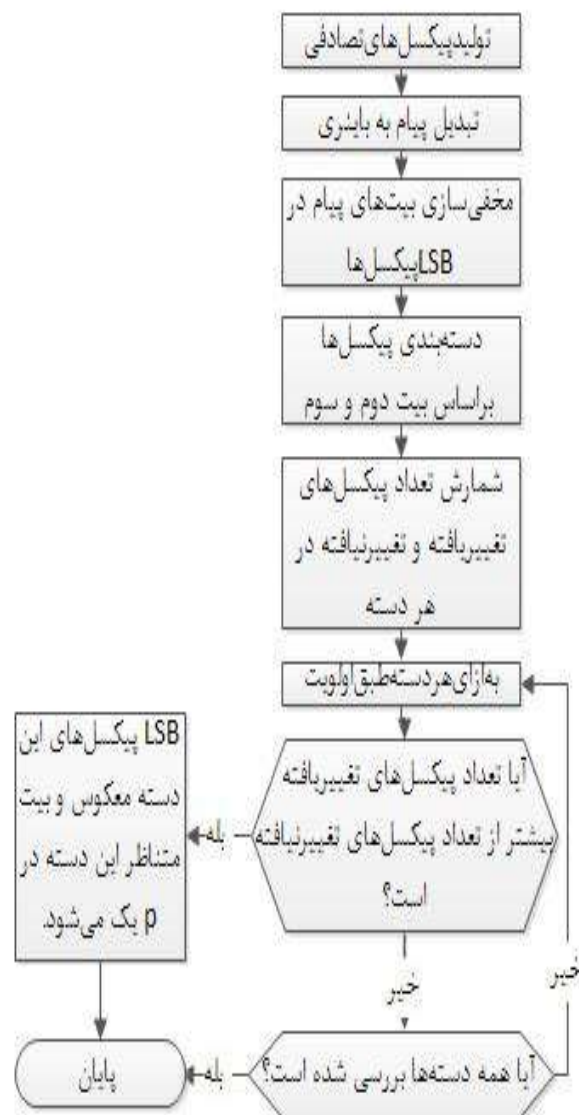
(شکل-۲): چارت روش دسته‌بندی پیکسل‌ها براساس بیت دوم و سوم کم‌ارزش آنها
