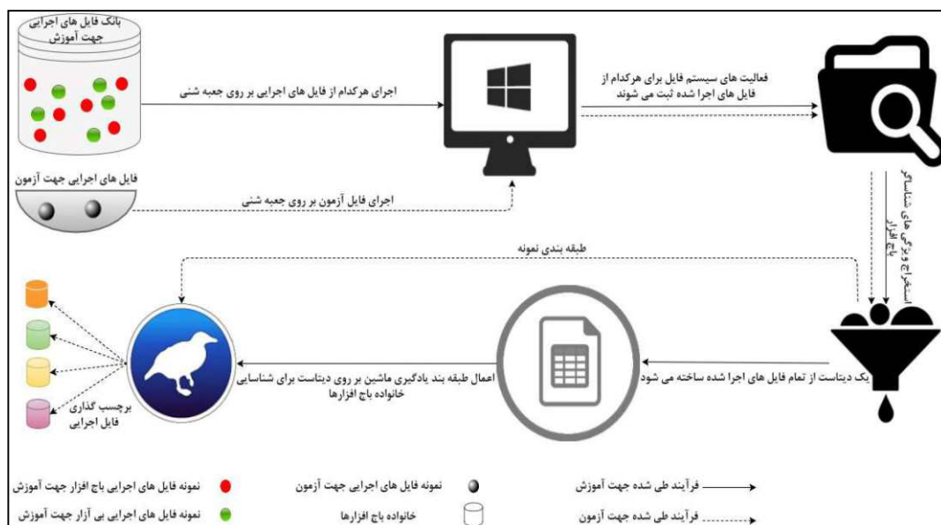
(شکل-۱): فرآیند طرح پیشنهادی (در معماری پیشنهادی ابتدا فایل اجرایی بر روی جعبه‌شنی اجرا می‌شود و سپس بر اساس ویژگی‌های مطرح شده که از تعاملات باج‌افزار با سیستم فایل استخراج می‌شوند و اعمال آن بر مدل ساخته شده می‌توان خانواده باج‌افزار را شناسایی کرد).
