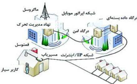
شکل ۲. مثالی از بکارگیری فموسل [۳]
